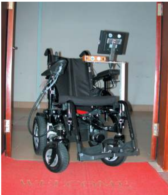
Hình 7: Xe lăn điện thông minh có thể sử dụng được cả trong trường hợp tay người sử dụng quá yếu, không có những phản ứng nhạy bén để điều khiển xe lăn tránh được một số vật cản trong khi di chuyển.
